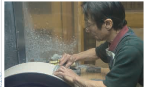
「うぶげや」ではお店の裏で、研ぎ作業を行う。2種類の回転砥石で肉厚を調整した後、目の細かい砥石を使い、昔ながらの手研ぎで刃先を仕上げているのである。
